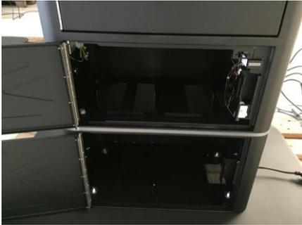
3. Stecken Sie bitte das Versorgungskabel, welches durch das unterste Element führt, ab und fädeln Sie danach bis in den mittleren Schacht durch
