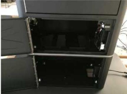
3. Débranchez le câble d'alimentation qui passe à travers l'élément le plus bas et enfitez-le ensuite jusqu'au puits central.
