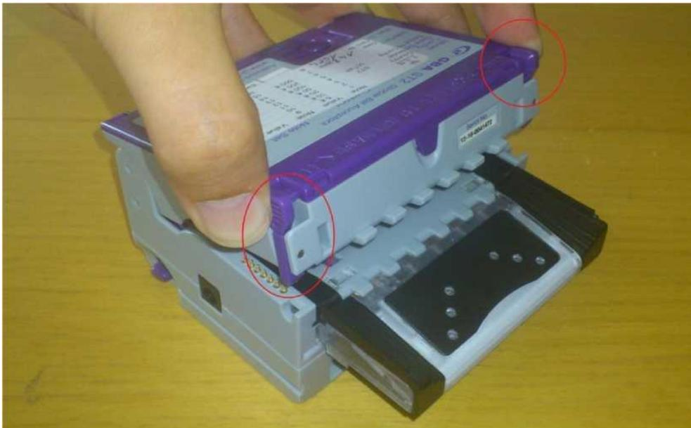
4. Veuillez utiliser un chiffon de coton ou un chiffon de nettoyage sans peluches et une solution de nettoyage — un mélange d'eau et d'alcool isopropylique (jusqu'à 50 %).
