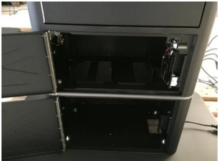
3. Αποσυνδέστε το καλώδιο τροφοδοσίας, το οποίο οδηγεί στο χαμηλότερο στοιχείο, και στη συνέχεια περάστε το στο μεσαίο άξονα
